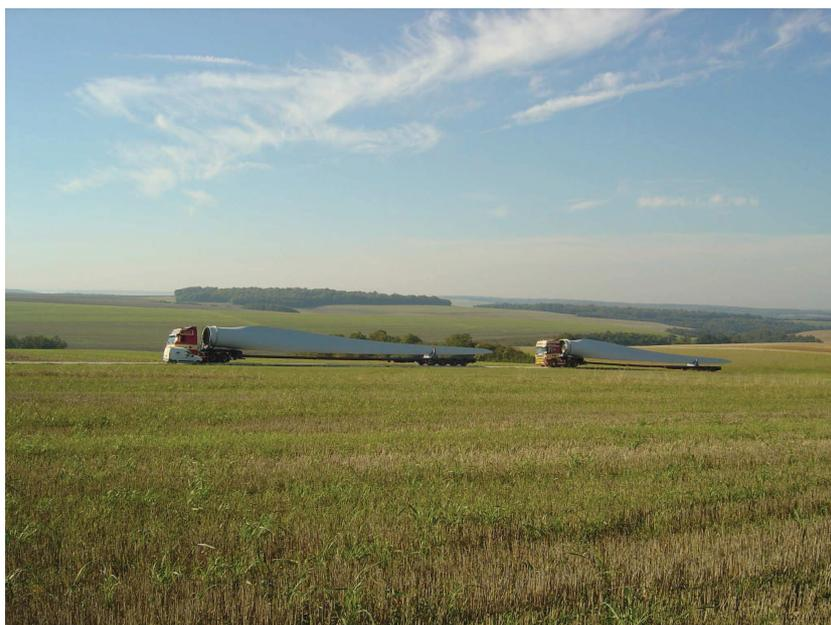
Figure 18 : Exemple de transport de pale par camion
